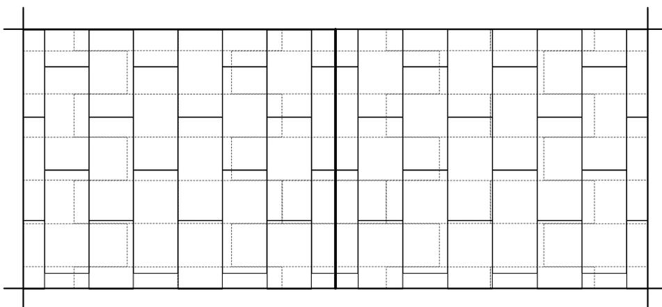
Disposizione sfalsata dei pannelli in cementolegno BetonWood® N rispetto ai pannelli fibra di legno Fibertherm® base sottostanti e giunto di dilatazione al centro (necessario in stanze e ambienti che superano i 40m²).
